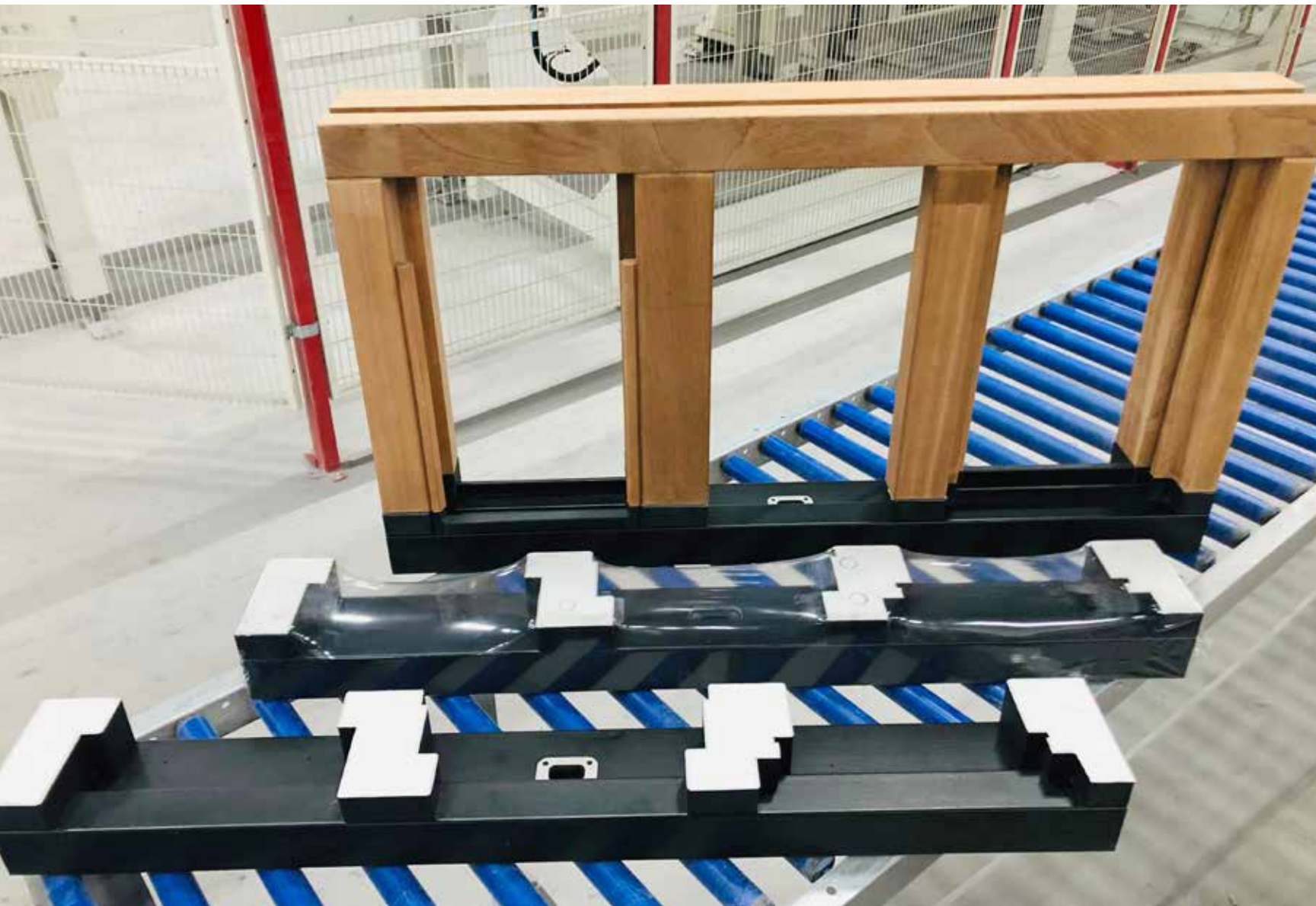
De combinatie draai/kiiep en vast glas zijn geschikt voor zowel de voormontage (NEO-FIX ingepakte dorpels) als voor de afmontage.
